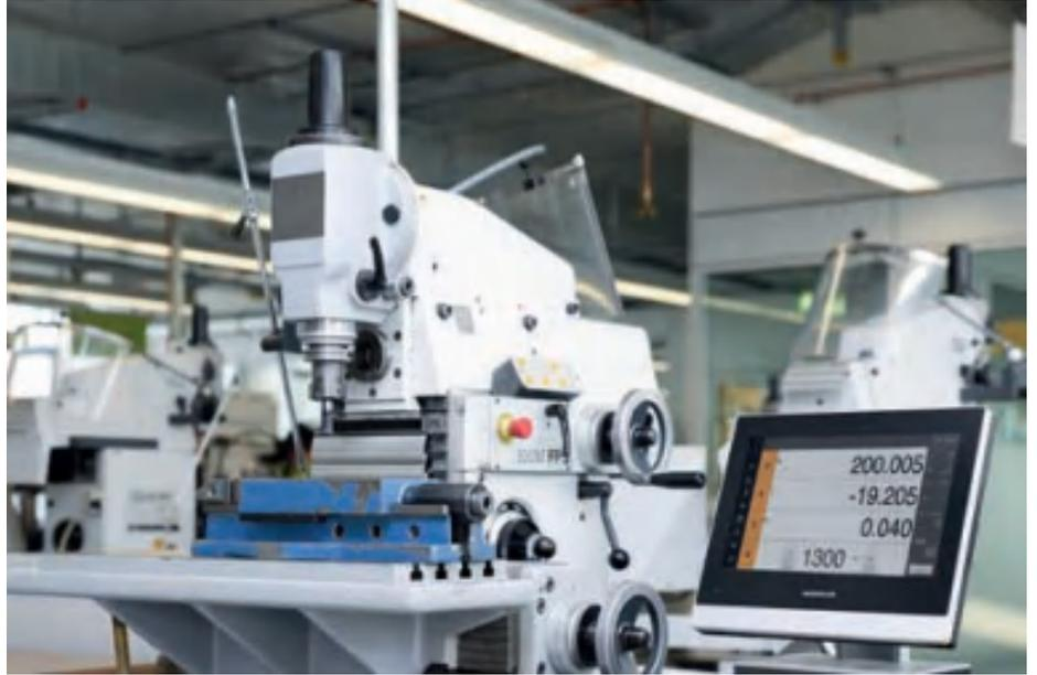
余程功能帮助机床操作员进行定位操作。只需将轴移到零显示值，便可轻松和可靠地定位到下一个位置。执行程序时，这个功能十分有用。
